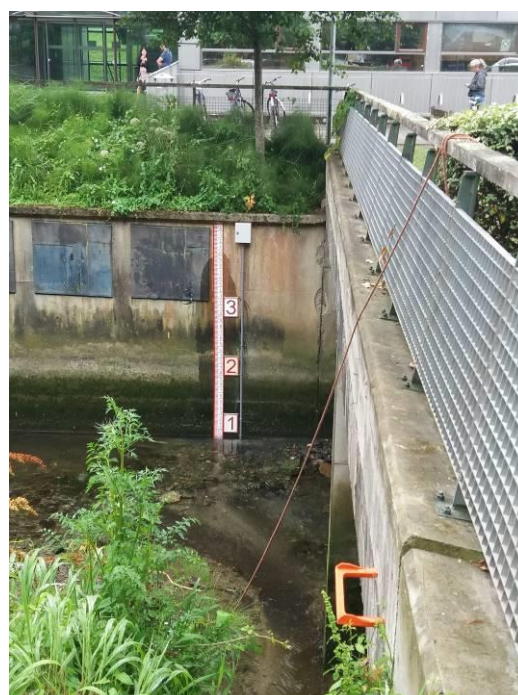
Figuras 2 y 3. Imágenes del mareógrafo instalado en el puerto (izda.) y del medidor de nivel del río Urumea en la zona de Txomin (dcha.)
